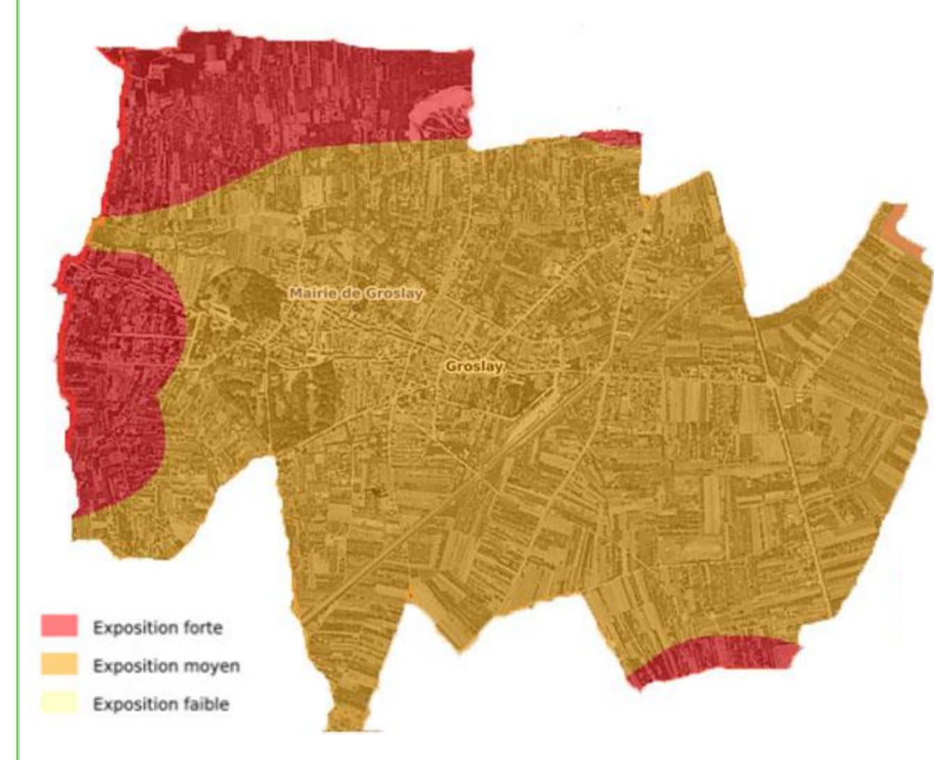
Risques de retraits et gonflements des sols argileux
